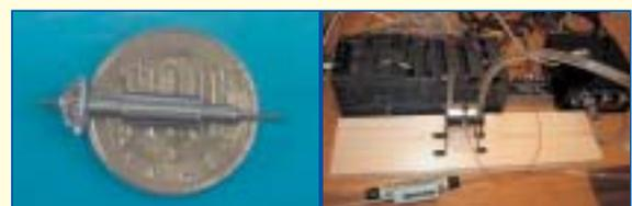
図3 羽根車外径8mmのラジアルタービン(左)と空気試験装置(右)
