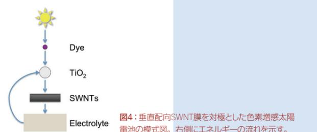
図4:垂直配向SWNT膜を対極とした色素増感太陽電池の模式図。右側にエネルギーの流れを示す。
